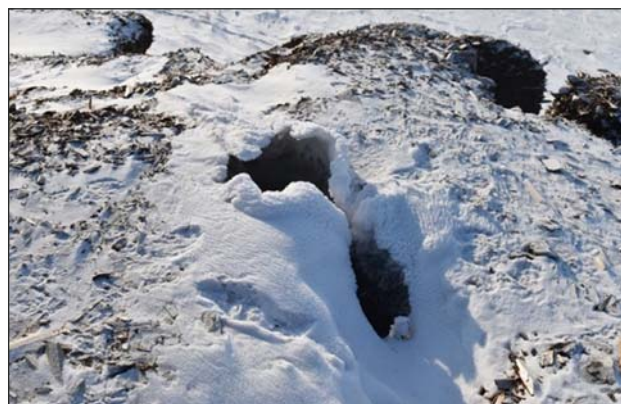
Рис. 8. Выход тёплого воздуха из трещин опилочных отходов (10.12.2022 г.) Fig. 8. Release of warm air from cracks in sawdust waste (December 10, 2022)
